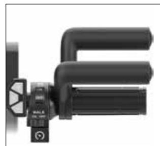
TETRAREGLAGE Speciala tetrahandtag med gas och broms. Full kontroll
